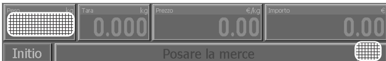
La bilancia è dotata di un dispositivo di azzeramento automatico, cioè, piccole variazioni del peso (per esempio residui sul piatto della bilancia) vengono compensate automaticamente. Il dispositivo di azzeramento non è in funzione, quando il peso di una confezione è tarato. Dopo l'eliminazione della sporcizia, quando la bilancia è accesa, nel display può essere visualizzato
